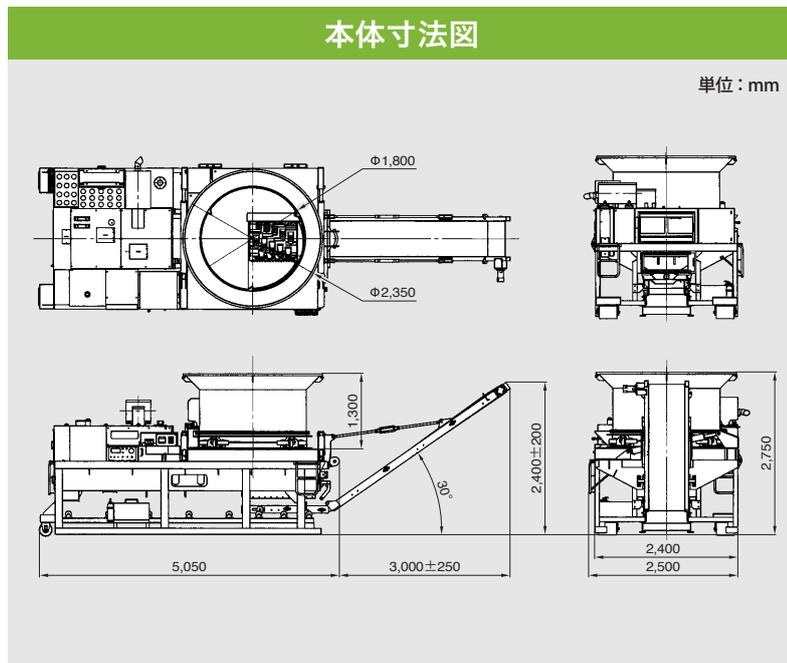
● 排出コンベアの取付寸法はコンベアの設置角度が30度の時の数値です。
