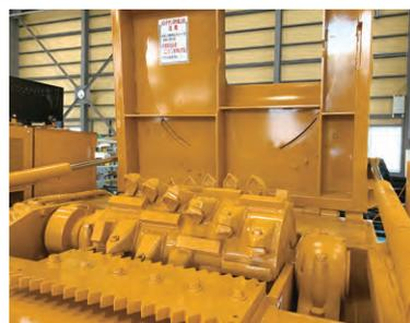
投入口ホッパー台は90°開閉可能で、スクリーンやカッター刃の交換や清掃、点検作業等のメンテナンスを容易に行えるシンプルな構造を採用しました。
